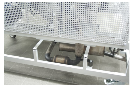
Abbildung zeigt den 4 Wege-Katalysator Partikelfiltersystem Für Ottomotoren
